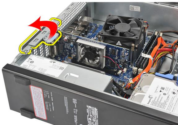
4. Presione la palanca de liberación para liberar la pestaña de seguridad de la muesca de la tarjeta.
