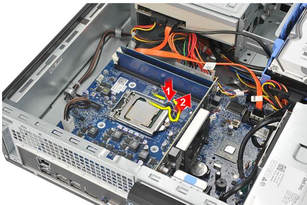
7. Levante la cubierta del procesador.
