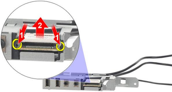
10. Extraiga el lector de tarjetas SD del soporte del panel de E/S.
