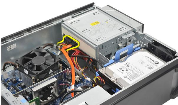
4. Tire del pestillo de liberación de la unidad óptica y empuje la unidad óptica hacia el frente del equipo.
