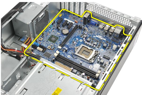
12. Levante la placa base fuera del equipo y colóquela en un envoltorio antiestático.
