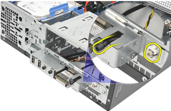
7. Extraiga el tornillo que fija el panel de entrada/salida al equipo.
